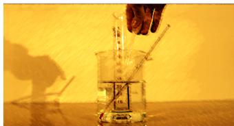
3. Stellt eure Standzylinder in die Wasserbecken. Befüllt eure Messzylinder mithilfe der Pipetten mit 20ml Wasser.
